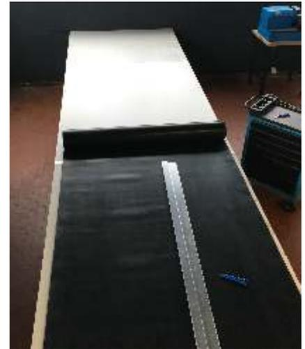
Schneidetisch für Gummi und Elastomere
