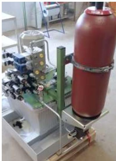
Hydraulikaggregat mit Speicher
